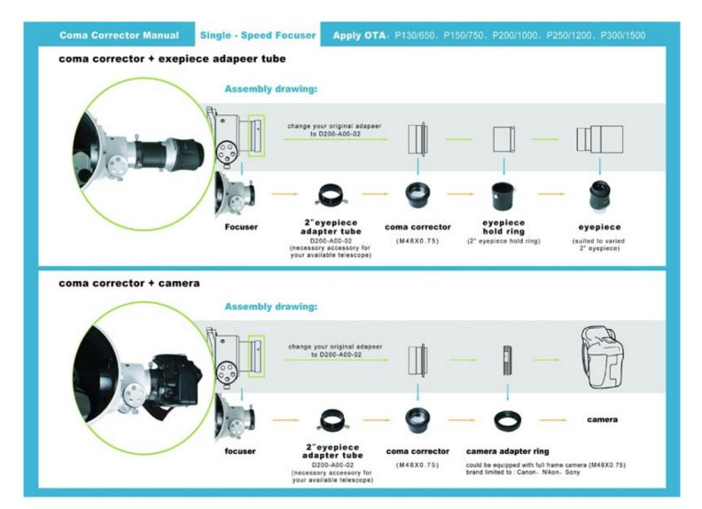
Anschlußschema für Skywatcher Newton und dem F5 Coma-Corrector von SW
