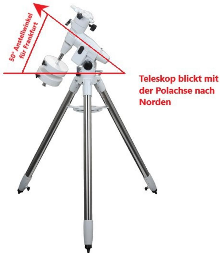
Da sich die Erde dreht und sich dadurch der Himmel von Osten nach Westen dreht, können wir nun die Himmelsobjekte mit der unteren Drehachse der Montierung bequem nachführen. Umso genauer Sie die Montierung ausnorden umso weniger müssen Sie später mit der oberliegenden Drehachse die Nachführung korrigieren.
