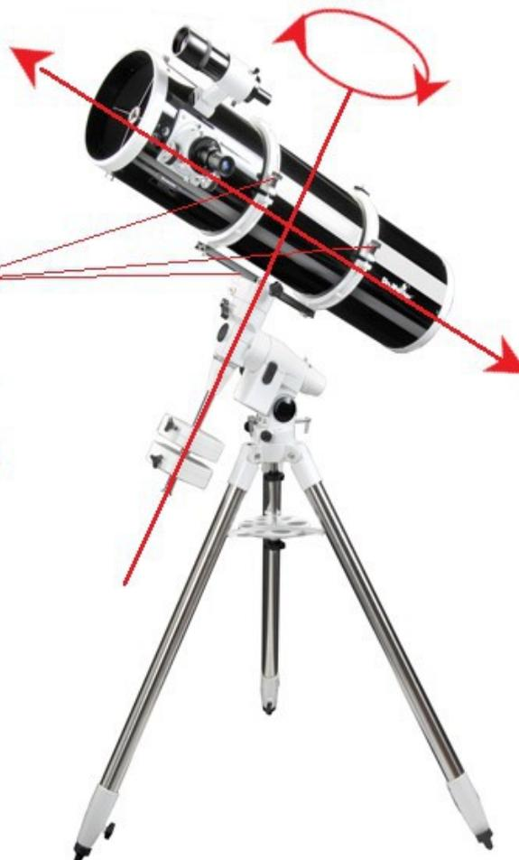
Verschieberichtung zum ausbalancieren rechts/links
