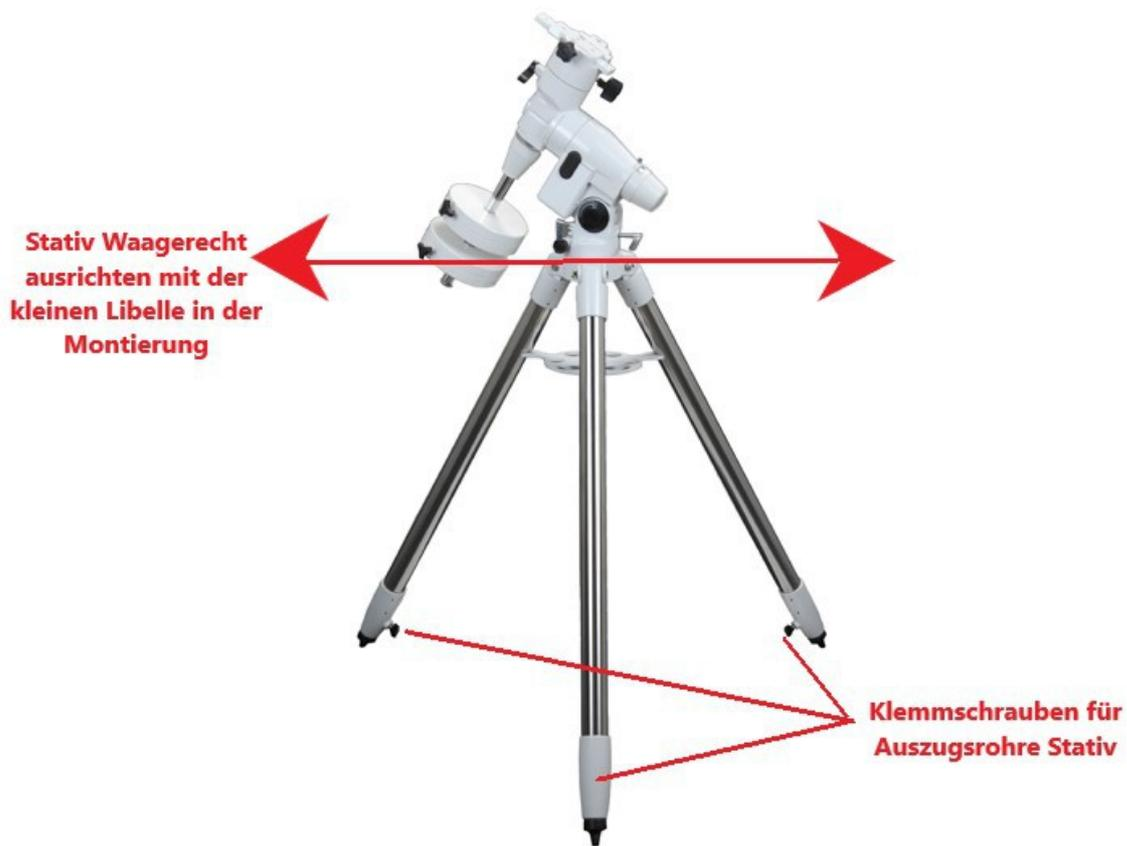
Bitte stellen Sie mittels der Einstellschrauben der Elevation nun  $50^\circ$  für Frankfurt ein. Durch lösen der einen Schraube und reindreihen der Anderen läßt sich die Neigung verstellen und einstellen. Wenn Sie woanders wohnen und beobachten stellen Sie dementsprechend einen passenden Wert ein.
